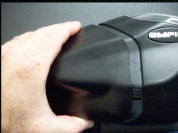
Retirez la partie frontale en appuyant sur le verrou du ressort inférieur et sur l'onglet supérieur, puis faites glisser la partie frontale vers l'avant (Figure 2.1).
