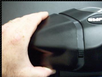
**Partie frontale-** Appuyez sur le verrou du ressort inférieur et sur l'onglet supérieur, puis faites glisser la partie frontale vers l'avant et retirez-la du bloc moteur (Figure 3.1).
