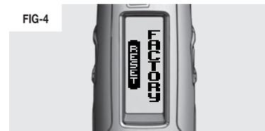
PRECAUCION: Cuando se selecciona FACTORY se eliminan todas las configuraciones guardadas por el usuario y se restablece la CS2 como cuando salió de la fábrica.
