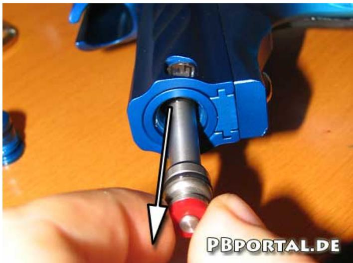
Nun kann der Rammer gereinigt und neu geölt werden (Bei der Gelegenheit können die O-Ringe und Bumper des Rammers auf eventuelle Beschädigungen oder Verschleiß geprüft werden).
