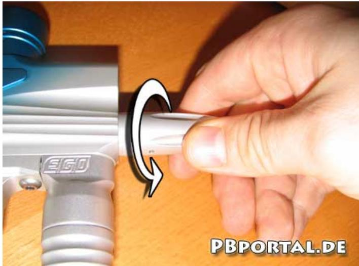
Somit kann der LPR Piston von Hand aus der LPR Cap herausgezogen werden. Auch die darunter liegende silberne LPR Front Spring kann nun aus der LPR Cap entfernt werden. Alle Teile sanft reinigen und mit einem Ölfilm überziehen.
