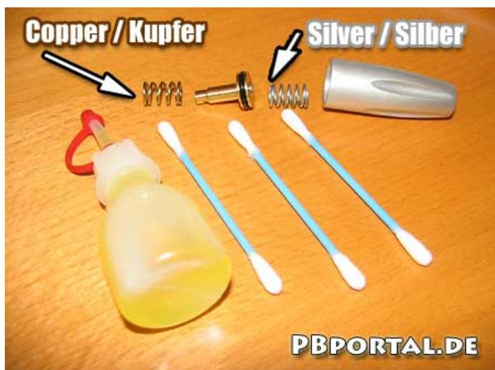
Nun kann die LPR Cap bereits wieder mit den Innereien bestückt werden. Hierzu zuerst die silberne Feder zuerst in die LPR Cap einlegen. Dann die bronzefarbene Feder auf den LPR Piston aufstecken und dann den LPR Piston mit sanftem Druck wieder in die LPR Cap einfahren
