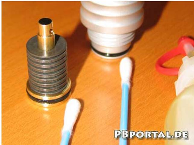
Somit kann auch das letzte Bauteil, die Inline Reg Schraube ausgebaut werden. Hierzu den Inline Bottom Reg umdrehen und die Inline Reg Schraube mit einem 1/8 Zoll Schlüssel im Uhrzeigersinn ganz in den Inline Bottom Reg **hinein** schrauben.
