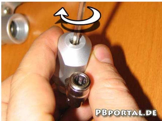
Sobald sich die Inline Reg Schraube nicht mehr tiefer hinein drehen lässt kann diese mit sanftem Druck durch den letzten O-Ring gedrückt werden. Auch dieses Teil sollte gereinigt und neu geschmiert werden.
