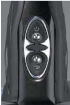
Der obere Schalter dient zum Einschalten der DM. Diesen Schalter ca. 2-3 Sek. halten, dann schaltet sie sich an, zu erkennen an der blauen LED.
