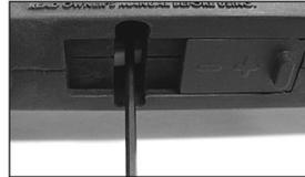
**Para incrementar la velocidad-** destornillar o desenroscar el tornillo de ajuste de velocidad haciéndolo girar hacia la izquierda del marcador (contra las agujas del reloj). Gire el tornillo de ajuste de velocidad en contra de las agujas del reloj poco a poco, deteniendo el movimiento entre uno y otro giro para comprobar la velocidad hasta
