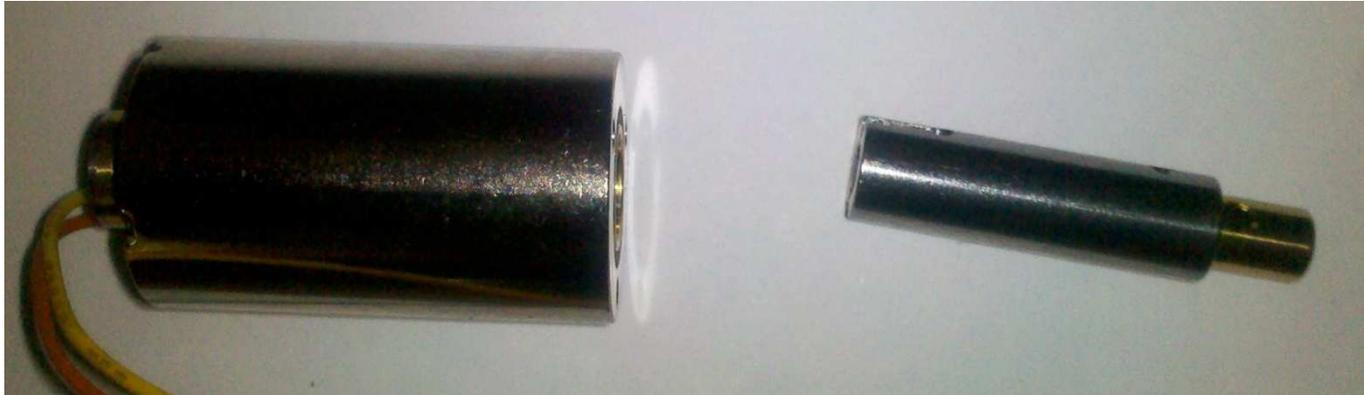
Der Piston lässt sich am besten mit einer Zange entnehmen, aber nur eine MIT GLATTEN BACKEN verwenden! Nach dem entnehmen alles schön fett- und schmutzfrei machen und wieder in umgedrehter Reihenfolge zusammenbauen.
