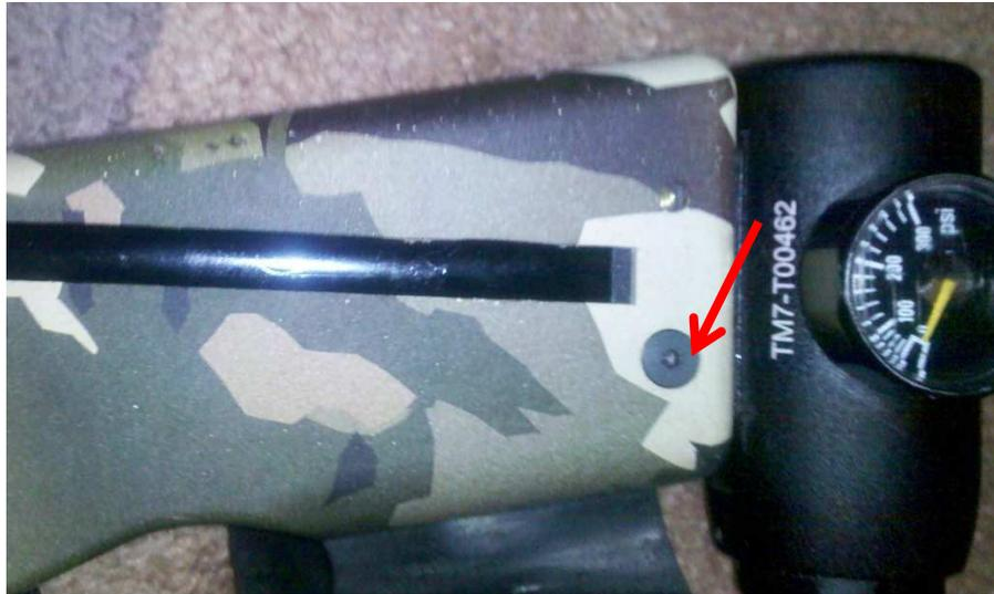
Zu Beginn empfiehlt es sich zuerst die Schraube am Frame anzuziehen. Danach fixiert man sämtliche Gehäuseschrauben und zieht diese abschließend mit Gefühl fest, das Gehäuse ist nicht aus Stahl.....
