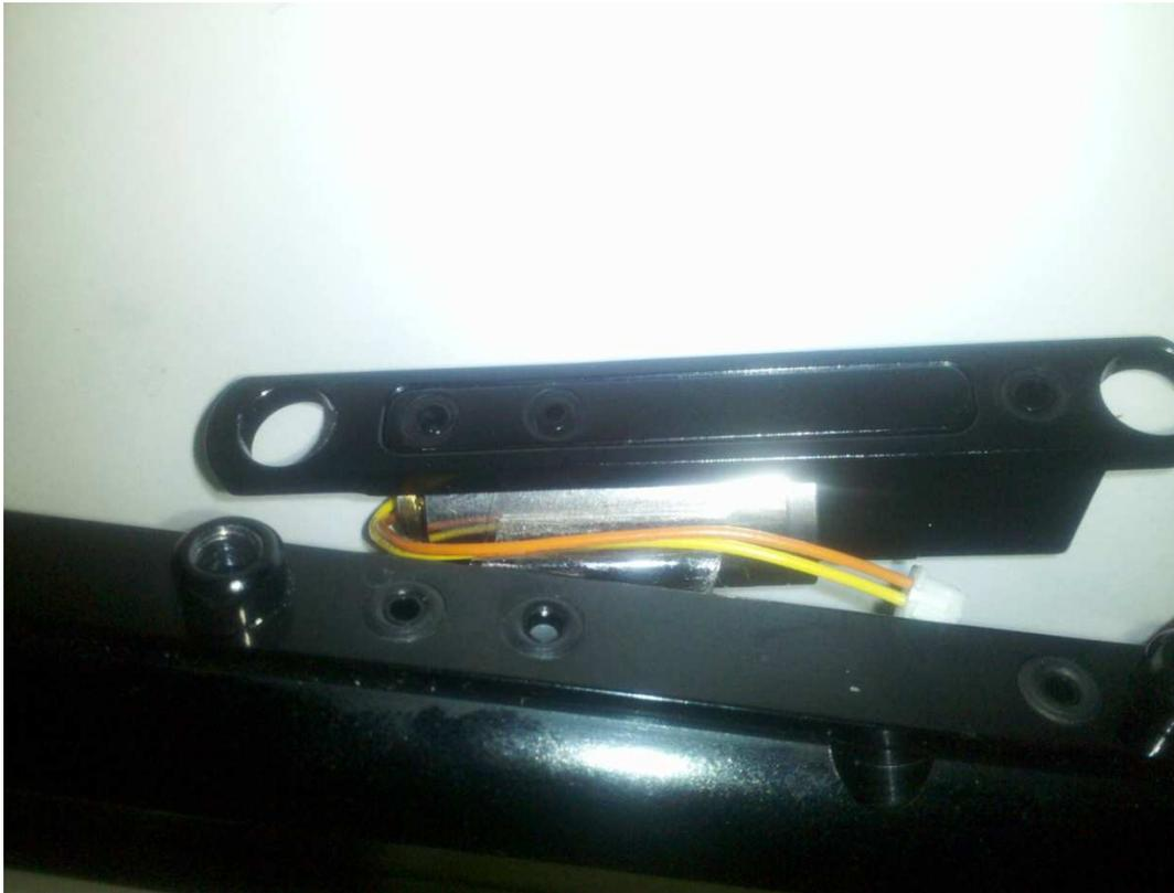
Dazu entfernt man einfach die beiden Schrauben die das Manifold mit dem Body verbinden.
