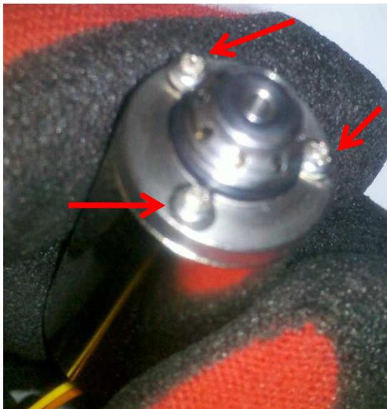
Diese 3 Schrauben müssen gelöst werden. Ein hochwertiger Kreuzschlitzschraubendreher ist hier Pflicht!!!!
