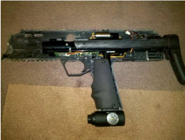
Zum entfernen der Schulterstütze einfach die Schulterstütze aus dem Gehäuse heben und herausziehen, dabei muss auch nicht der Verstellhebel betätigt werden.
