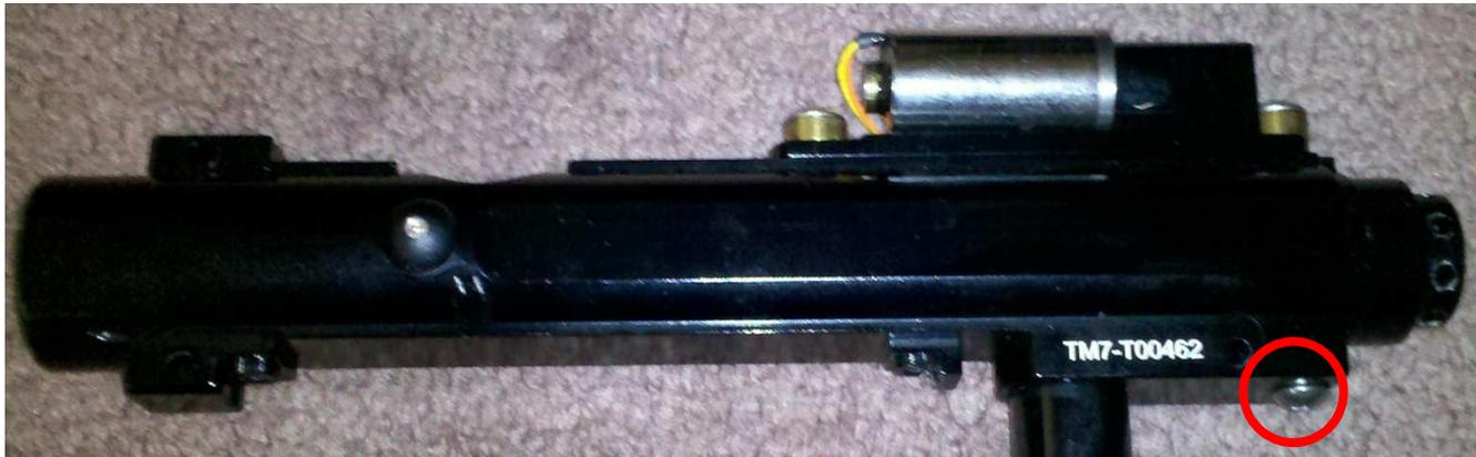
Zum Entnehmen des Bolzenpakets **diese Schraube** lösen.
