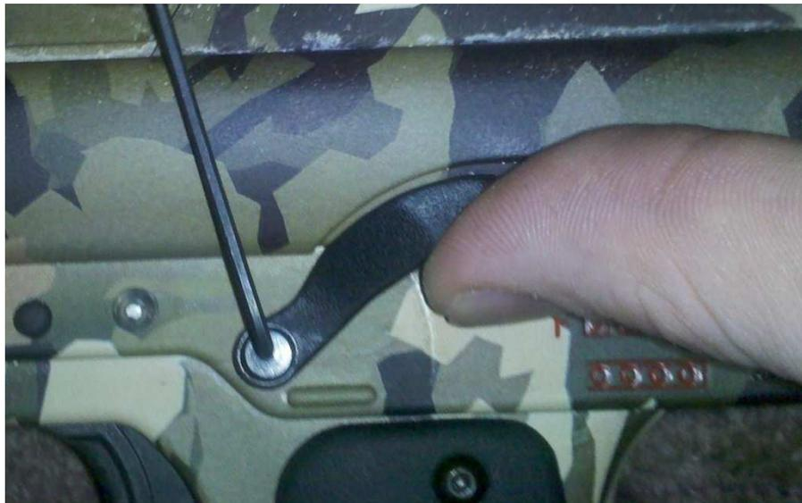
Beim Anschrauben des Feuerwahlhebels drückt man diesen am besten mit dem Finger in die Safe-Position und hält diesen auch dort wenn man die Schraube anzieht, der lange Hebel (und auch Kraft) tut den Anschlag im Inneren nicht besonders gut.
