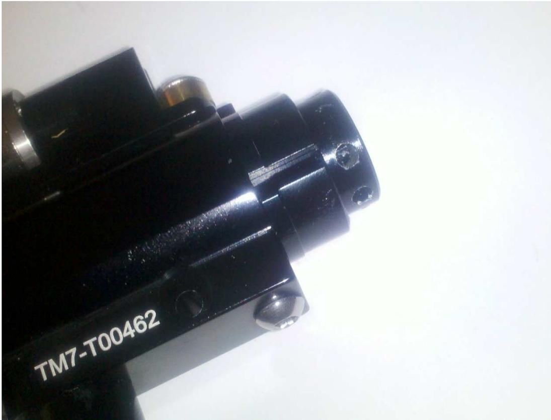
Das Fertige Bolzenpaket wird jetzt genommen und wieder in den Mainbody gesteckt. Verdrehen kann man es nicht weil es mit dem hinteren Teil (Velocity Adjuster oder FPS-Schraube) durch einen Stift gegen Verdrehen gesichert ist.
