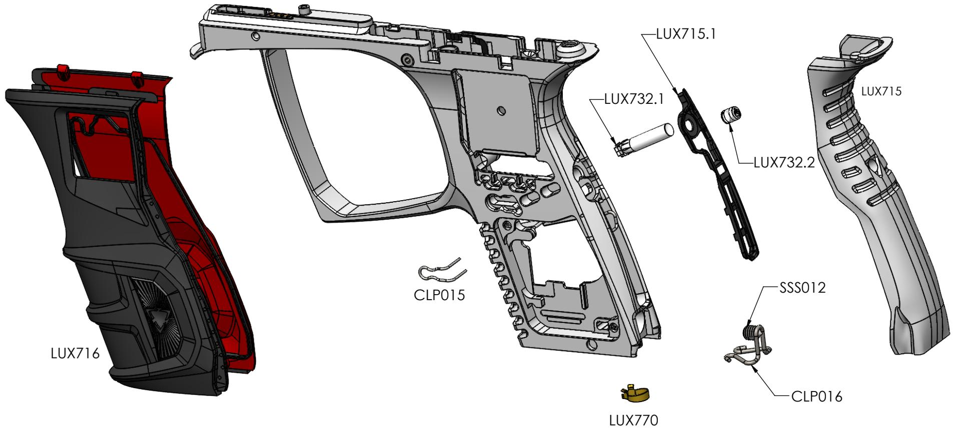
1. SLIDE LUX716 ON TO TRIGGER FRAME
