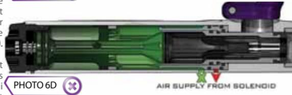
La durée pendant laquelle le Bolt est maintenu vers l'avant est déterminé par le réglage du Dwell. Lorsque le temps du Dwell est fini, le Solenoid dirige l'air vers le Can ce qui remet la culasse dans sa position d'origine. Simultanément la chambre de tir est remplie d'air par le solenoid à la pression réglé sur le regulateur inline par l'utilisateur et le Prop Shaft est poussé vers l'arrière dans sa position initiale par la pression contenue dans le CAN. (photo 6E).
