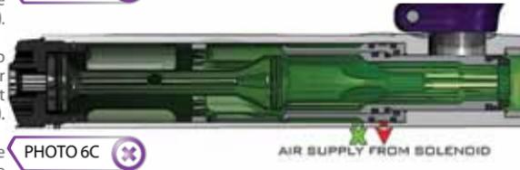
Comme l'air de la chambre de tir est expulsé la force maintenant le Prop Shaft vers l'arrière est inférieure à la tension du ressort du Back Cap. Le ressort pousse alors le Prop Shaft vers l'avant. Le joint sur le Prop Shaft en entrant dans la culasse recrée une étanchéité parfaite de la chambre de tir (photo 6D).
