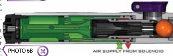
Dès que la culasse passe le joint du "Front Prop Shaft" la chambre de tir n'est plus étanches et l'air va de la chambre de tir vers la culasse ce qui permet de propulser correctement la bille (photo 6C).
