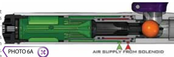
Lorsqu'une bille est chambrée et que la détente est actionnée, un signal est envoyé au Solenoid qui stop l'alimentation en air de la chambre de tir permettant ainsi à l'air se situant dans "le can" d'être expulsé. Ce qui retire la force qui maintient la culasse vers l'arrière et propulse cette dernière vers l'avant (photo 6B).
