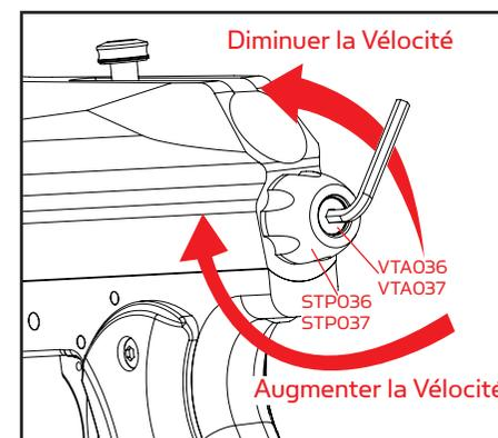
Pour **AUGMENTER** la vitesse FPS (feet per second = pieds par seconde) utilisez la clef six pans et tournez la pièce VELOCITY ADJUSTER/SPRING GUIDE dans le sens des aiguilles d'une montre.
