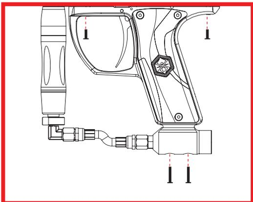
Avant/après l'utilisation du lanceur de paintball, s'assurer que toutes les vis sont bien serrées. Éviter de perdre des vis permet de garantir le bon fonctionnement du lanceur.
