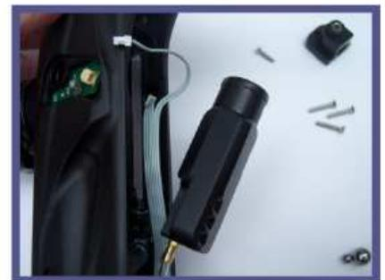
Lege das LPR Einstellbauteil bei Seite und hebe den LPR weg vom Body. Der Schlauch muss nicht entfernt werden.
