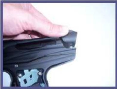
Entferne die Engine indem du die Backcap so hochhebst, bis der Haltepin frei wird. Dann ziehe die Engine nach hinten heraus
