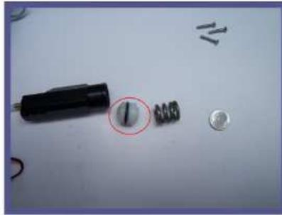
Wische alles alte Fett ab und fette das LPR Piston neu. Das Piston hat neben dem Oring einen Bereich in dem sich Fett sammelt, dieser hilft die Wartungsintervalle herabzusetzen, da der Oring über diesen Bereich mit Fett versorgt wird.
