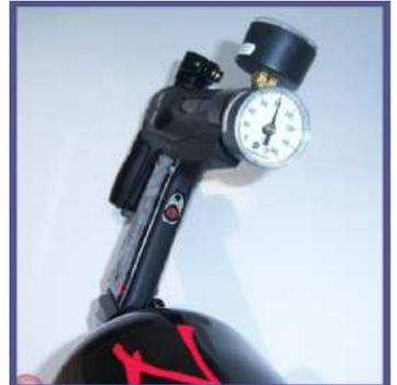
Das LPR Manometer zeigt an deinem Markierer nach hinten, das HPR Manometer nach oben. Die Manometer an deinem Tool können anders aussehen als auf dem Bild. Die Funktion ist die Gleiche.
