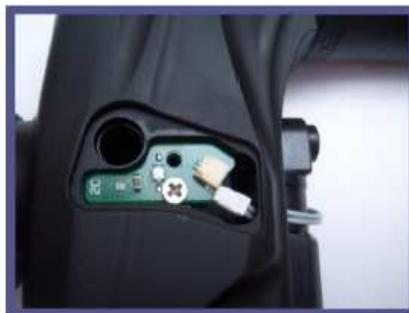
Trenne das Kabel des rechten Augenboards, falls das LPR Einstellbauteil entfernt werden soll. Das Entfernen des Einstellbauteils ist Optional.
