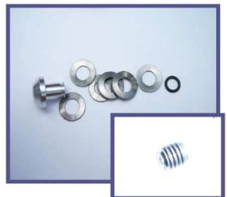
*Federnpaket zerlegt, mit dem einzigen Oring, der nicht gefettet werden muss*
