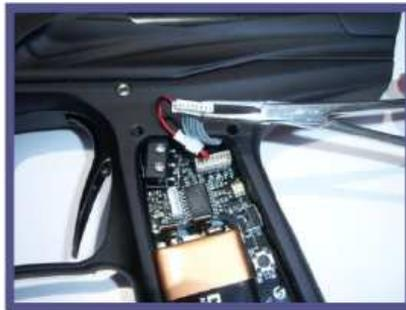
Trenne das Kabel vom Board indem du am Stecker ziehst, nicht am Kabel selbst. Merke dir wie die Kabel und Löcher versetzt sind. Du wirst beim Zusammenbau ausrichten müssen.
