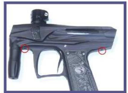
Entferne die vordere und hinter Griffschraube. Du wirst evtl. beim Lösen abwechselnd die vordere und die hintere Schraube losschrauben müssen. Da sie vom Griff festgehalten werden.
