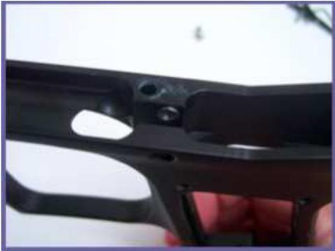
Wenn der Trigger wieder installiert wird, achte darauf, dass die Achsunterlegscheibe korrekt plaziert ist. Falls nicht wird der Trigger blockieren.
