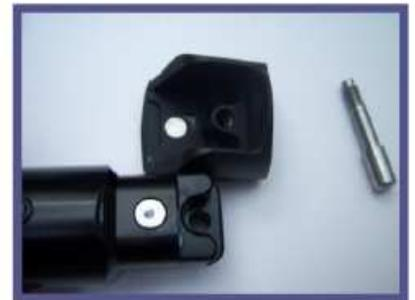
Die Backcap kann demontiert werden, indem der Haltepin abgeschraubt wird. Beim Zusammenbau soll keine Gewalt angewendet werden, ein Tropfen blaues Loctite hilft. Unter normalen Umständen müssen Backcap und Backblock nicht entfernt werden.
