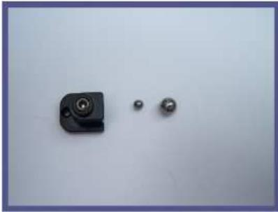
Wenn das LPR Einstellbauteil entfernt wurde, sind euch evtl. 2 Kugeln herausgefallen. Einer grösser, der andere kleiner. Wisch sie einfach sauber und stecke zuerst die Kleine zurück in das Bauteil, dann die grössere. Ein kleiner Tropfen blaues Loctite auf die LPR Einstellschraube bewart diese von versehentlichem Verstellen.
