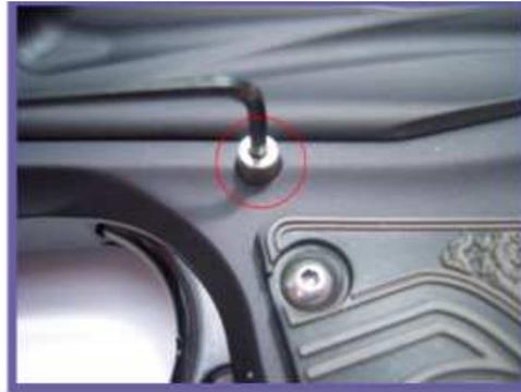
Um den Trigger zu entnehmen muss die Achsschraube entfernt werden.
