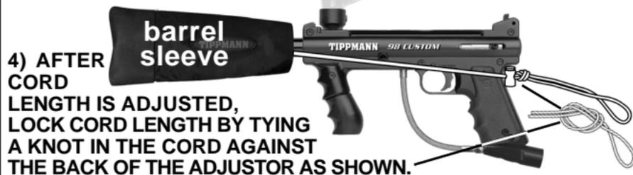
4) AFTER CORD LENGTH IS ADJUSTED, LOCK CORD LENGTH BY TYING A KNOT IN THE CORD AGAINST THE BACK OF THE ADJUSTOR AS SHOWN.
