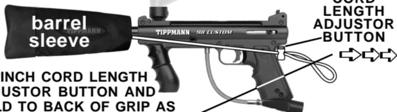
2) PINCH CORD LENGTH ADJUSTOR BUTTON AND HOLD TO BACK OF GRIP AS YOU PULL CORD THROUGH IT UNTIL ADJUSTOR IS SNUG AGAINST BACK OF GRIP, THEN RELEASE BUTTON.
