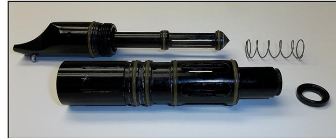
3. Saque el bulón de la parte trasera de la guía neumática.
