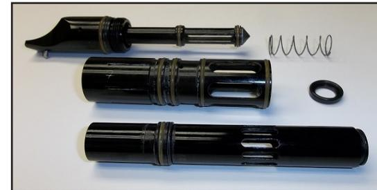
4. Desensrosque la guía del bulón de la tapa trasera. Retire la grasa vieja y los residuos del motor de disparo.
