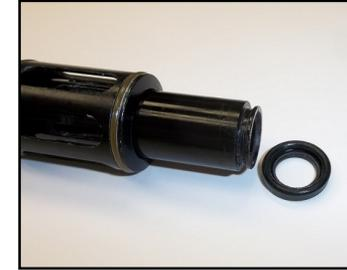
2. Desenrosque la guía neumática al girar la guía neumática hacia la izquierda para retirarla de la tapa trasera. El resorte del bulón saldrá junto con la guía del bulón.
