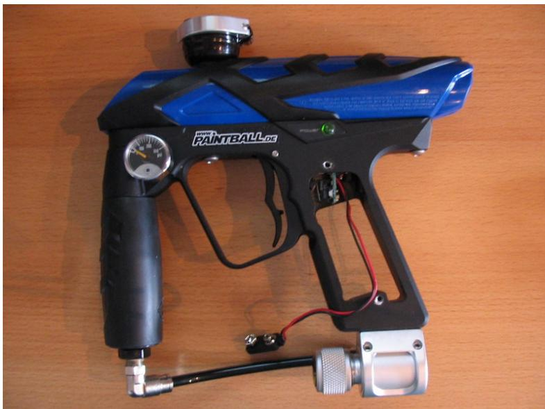
Als erstes die 4 Schrauben der Griffschale lösen und diese sowie die Batterie entfernen.
