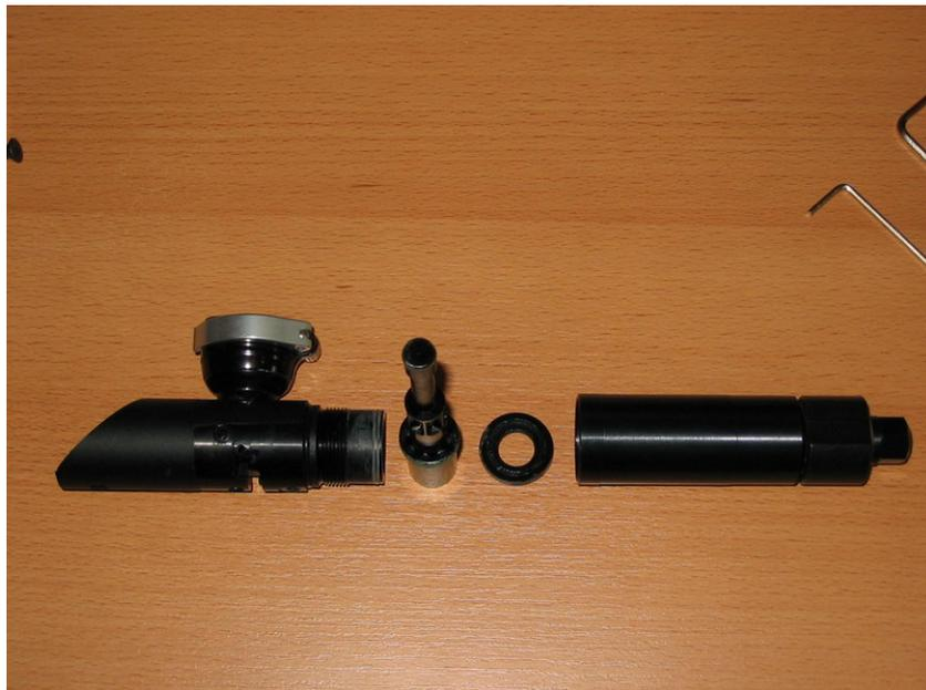
Die „Fire-Chamber“ vom vorderen Teil (Body-Breech) der Ion durch aufdrehen trennen, Bolt und Bolt-Stop entnehmen. (Bitte merken wie der Bolt-Stop verbaut war)
