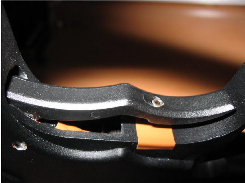
5. Dann die Schraube im Frame selber (deswegen Griffschale ab) so weit rein oder raus drehen das noch ca. 1-2mm vor dem auslösen Luft sind. Die Schraube kann sehr schwer gehen die ersten male, fühlt sich evtl. so an als ob sie abbricht. Das ist aber normal.
