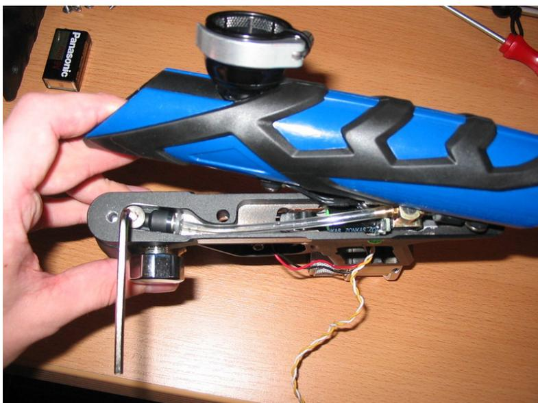
Anschließend das Board **etwas** raus drücken (was beim ersten mal recht schwer sein kann) und **vorsichtig** den Body zur Seite neigen, und mit die Verbindung des Banjo-fittings zum Triggerframe lösen.
