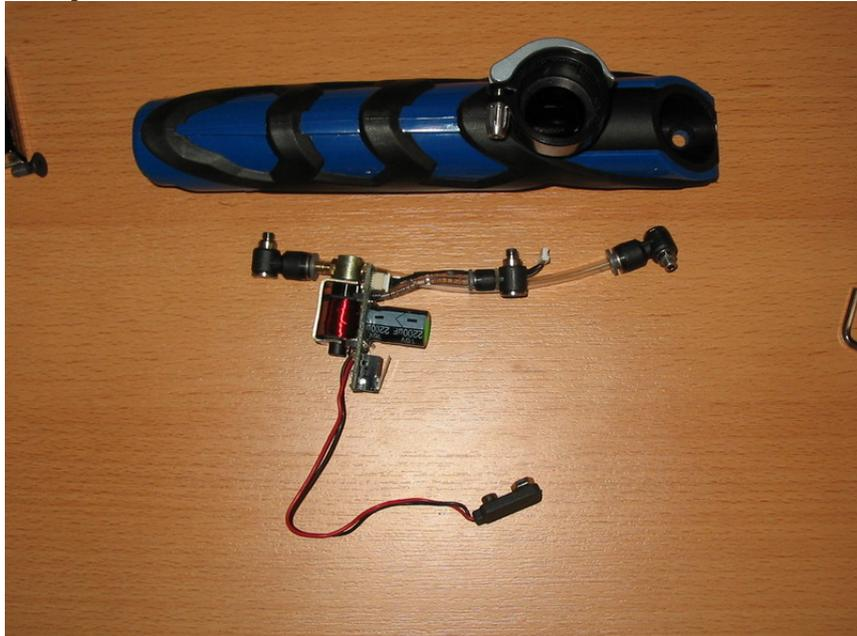
Kabel an das Board löten (Ein und Ausgang der Spule) am besten wie auf dem Bild von der Platinen Seite her.
