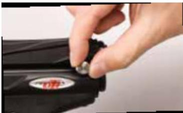
Figura 8. Retire el pasador de pelado de campo para empezar el desarmado.
