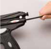
Figura 6. A Llave de 3/16" allen usada para ajustar la velocidad.
