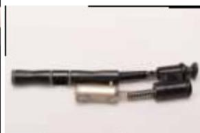
Figura 11 Unidad de perno/martillo retirada.
