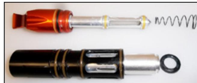
3. Saque el bulón de la parte trasera de la guía neumática.
