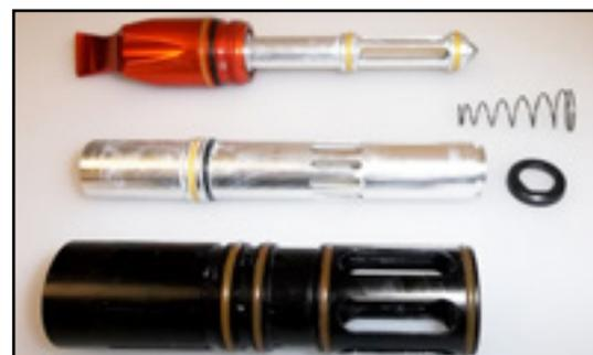
4. Desenrosque la guía del bulón de la tapa trasera. Retire la grasa vieja y los residuos del motor de disparo.
